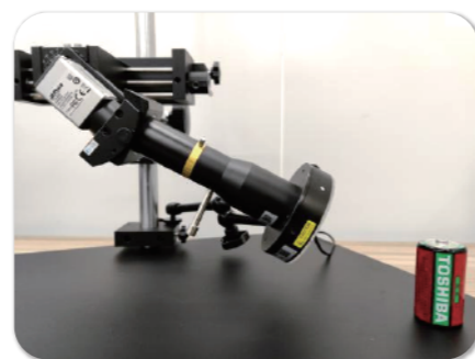
斜像远心镜头倾斜拍摄
