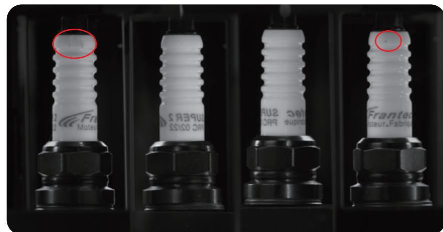
远心式侧面多视角镜头单次拍摄
