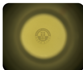
8mm焦距广角FA镜头在工作距离1mm时的测试图（内底面不完整）
